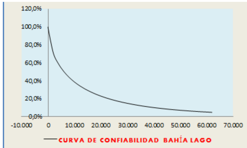
Figura 38. Curva confiabilidad para el circuito 13.8 kV Lago.
