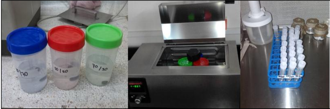
Figura 9. Montaje utilizado en las pruebas de bioactividad para las probetas de Ti_6Al_4V recubiertas.
