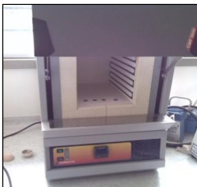
Figura 6. Horno utilizado para el tratamiento térmico de las probetas de Ti_6Al_4V .
