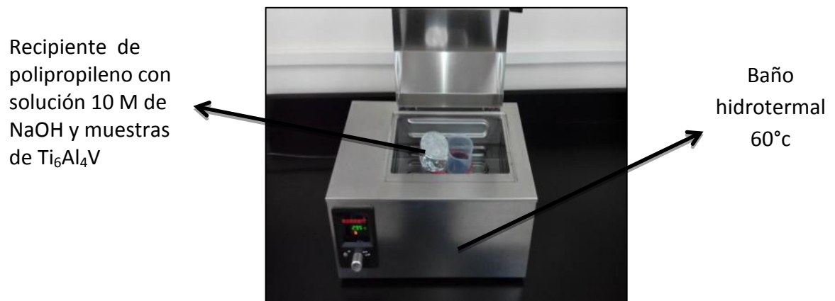
Figura 5. Montaje utilizado para tratamiento alcalino de las probetas de Ti 6 Al 4 V.
