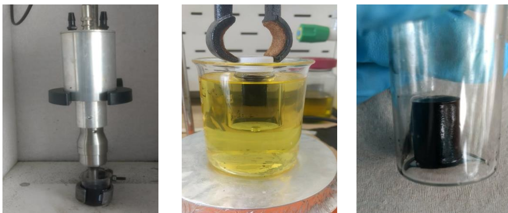
Figura 9. (a) Aplicación de ultrasonido a la solución de óxido de grafito. (b) Montaje de baño de aceite para la reducción del óxido de grafeno (c) Óxido de grafeno reducido funcionalizado con nanopartículas metálicas.
