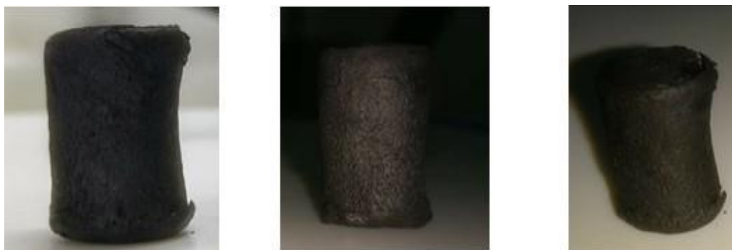
Figura 10. Espumas de óxido de grafeno funcionalizadas con nanopartículas de oro y plata.
