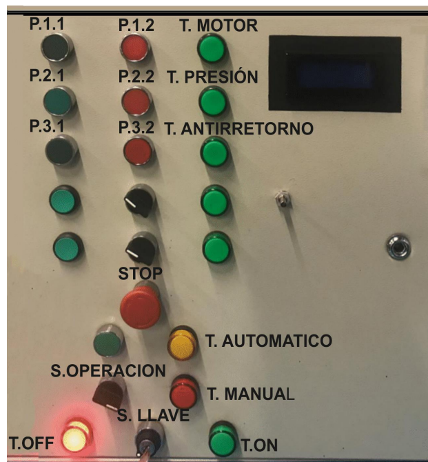
Figura 23. Elementos de lógica cableada.
