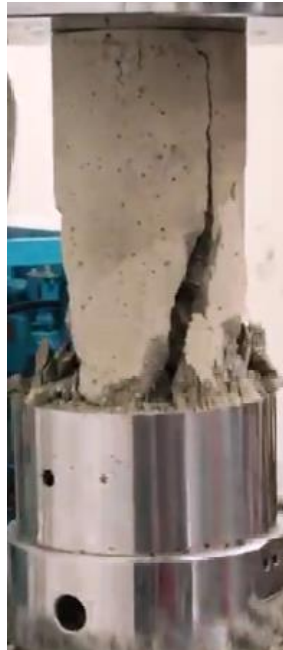
Figura 111. Rotura cilindro de concreto.
