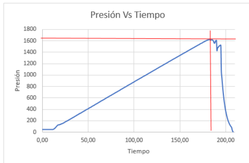
Figura 108. Rampa hasta rotura aplicada a madera.
