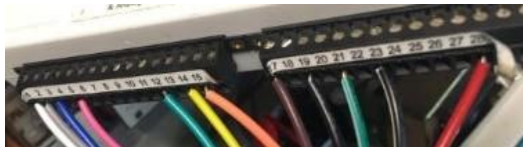
Figura 43. Conexión de elementos en tarjeta NI USB DAQ 6212.
