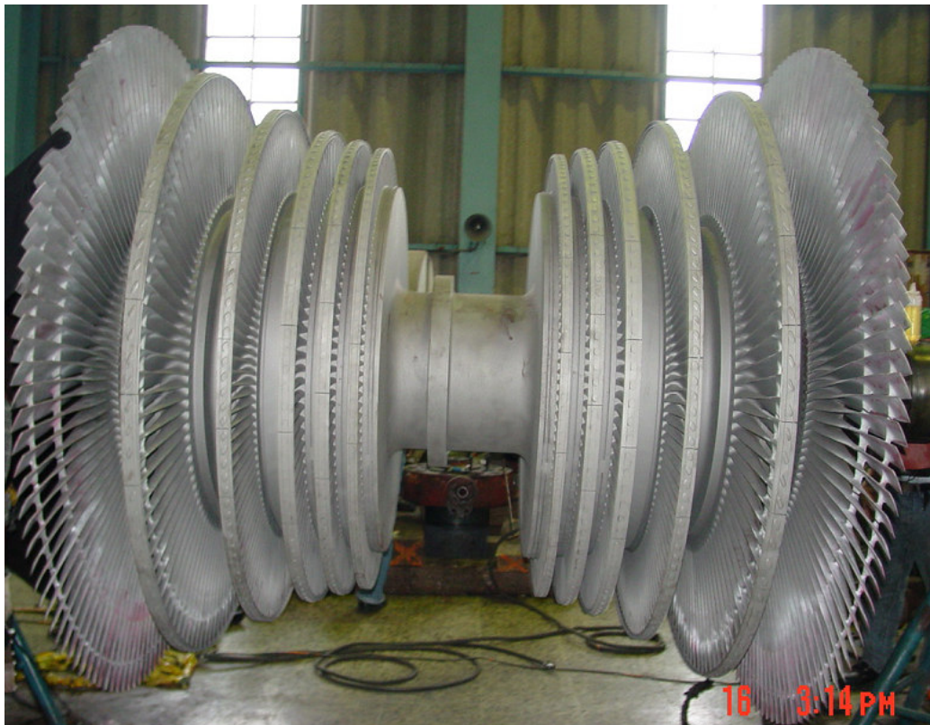
Figura 10. Alabes de turbina a vapor.
