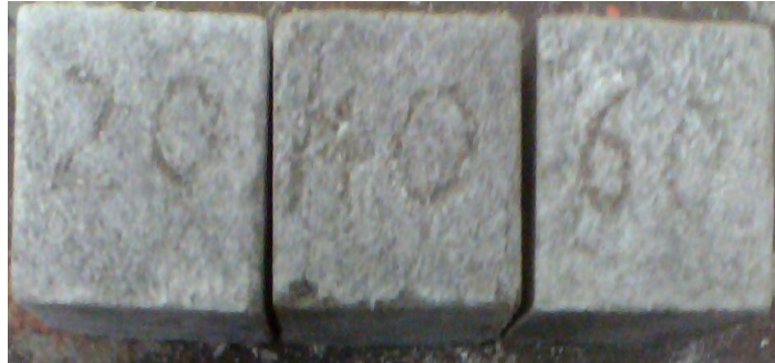
Figura 5. Muestras utilizadas en el ensayo de porosidad.
