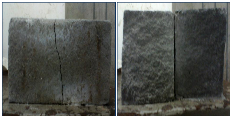
Figura 19. Falla de probetas con 40% de colas en arena.
