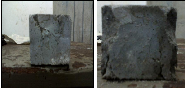
Figura 15. Deterioro de probetas con 60% de colas en arena.
