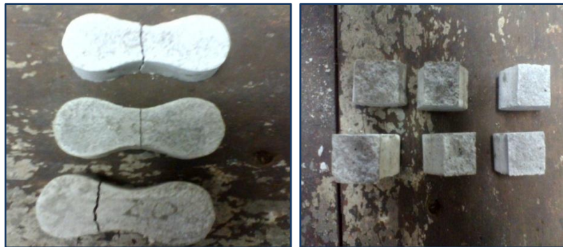
Figura 18. Falla de probetas con 40% de colas en arena.
