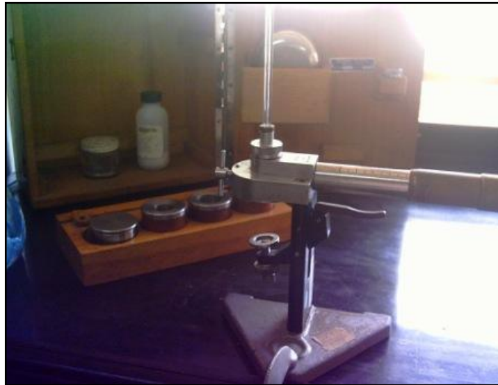
Figura 4. Porosímetro de Campo Ruska.
