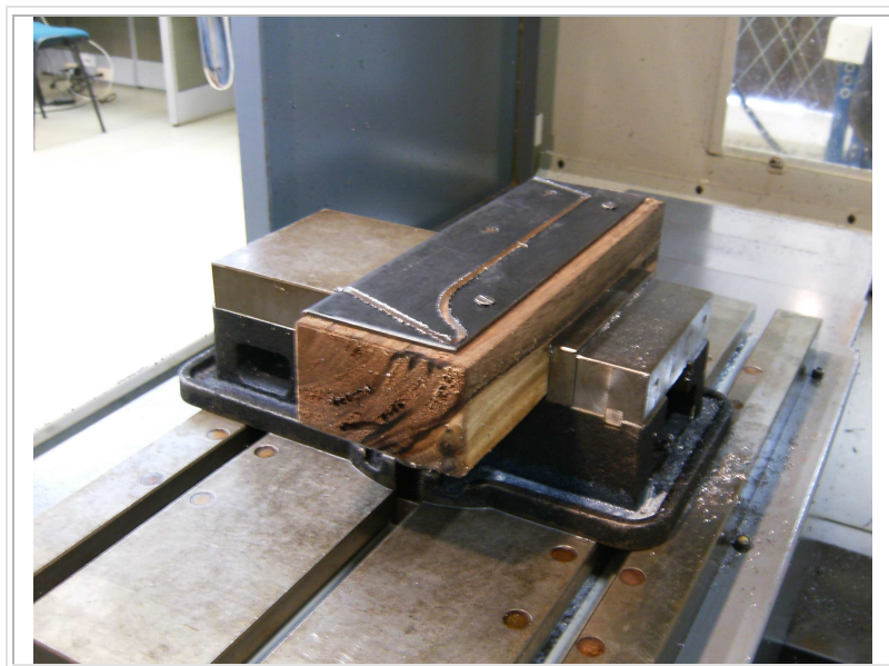
Figura 34. Sujeción del cuerpo a la mesa del centro de mecanizado.
