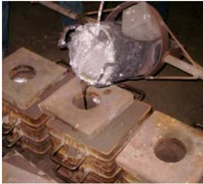
Vaciado en moldes
