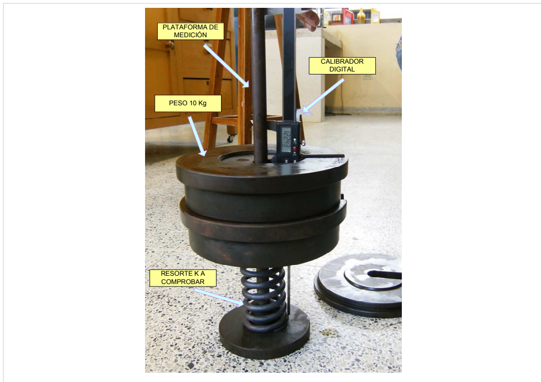
Figura 45. Comprobación de la constante de elasticidad del resorte.
