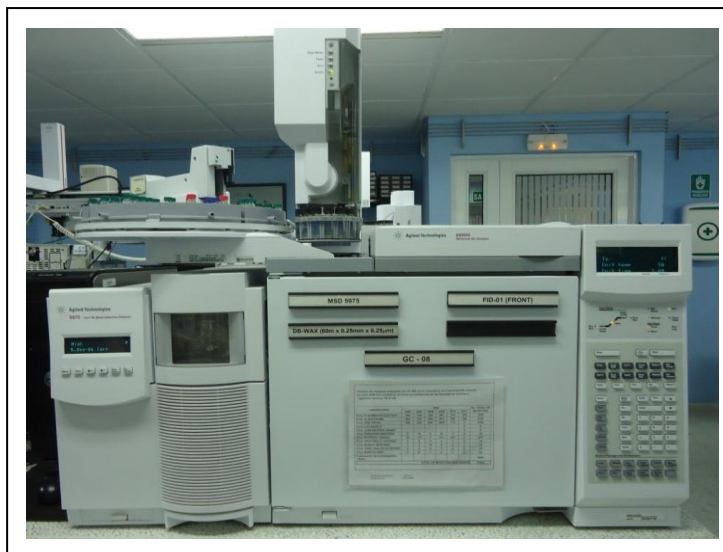
Figura 18. Cromatógrafo de gases Agilent Technologies 6890N Network Series GC acoplado a un detector selectivo de masas Agilent Technologies 5975 Inert XL . Fotografía tomada por Yaride Pérez Pacheco. Lugar: Laboratorio de instrumentación analítica, CENIVAM, UIS. Fecha: Marzo de 2012.
