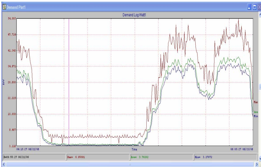
FIGURA 4.4 POTENCIA ACTIVA EN LA FASE A
