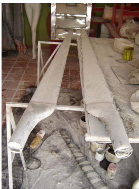
Pala solidificada, una con pulida del pegue y la otra en proceso.
