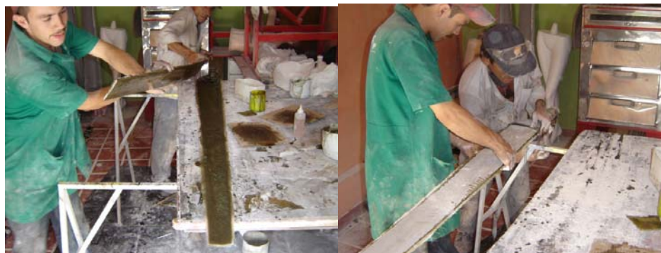
Unión de las dos partes de la pala y amarre para secado.
