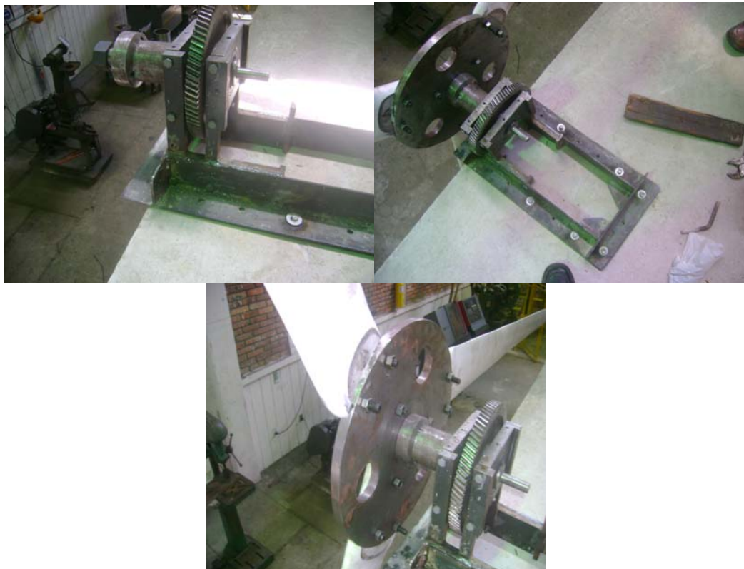
Montaje de la estructura del SICOE para las pruebas de balanceo.
