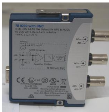
Figura 57. Tarjeta de adquisición de datos NI9230- Conexión BNC
