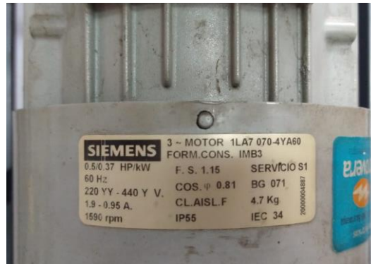
Figura 30. Placa del motor SIEMENS disponible para el banco
