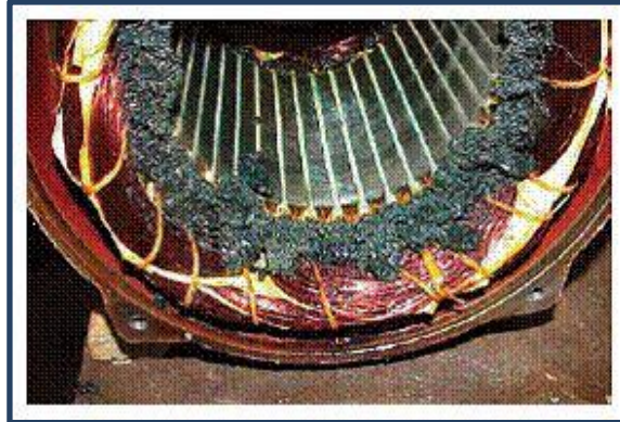
Figura 18. Daño de motores eléctricos por sobre-lubricación.
