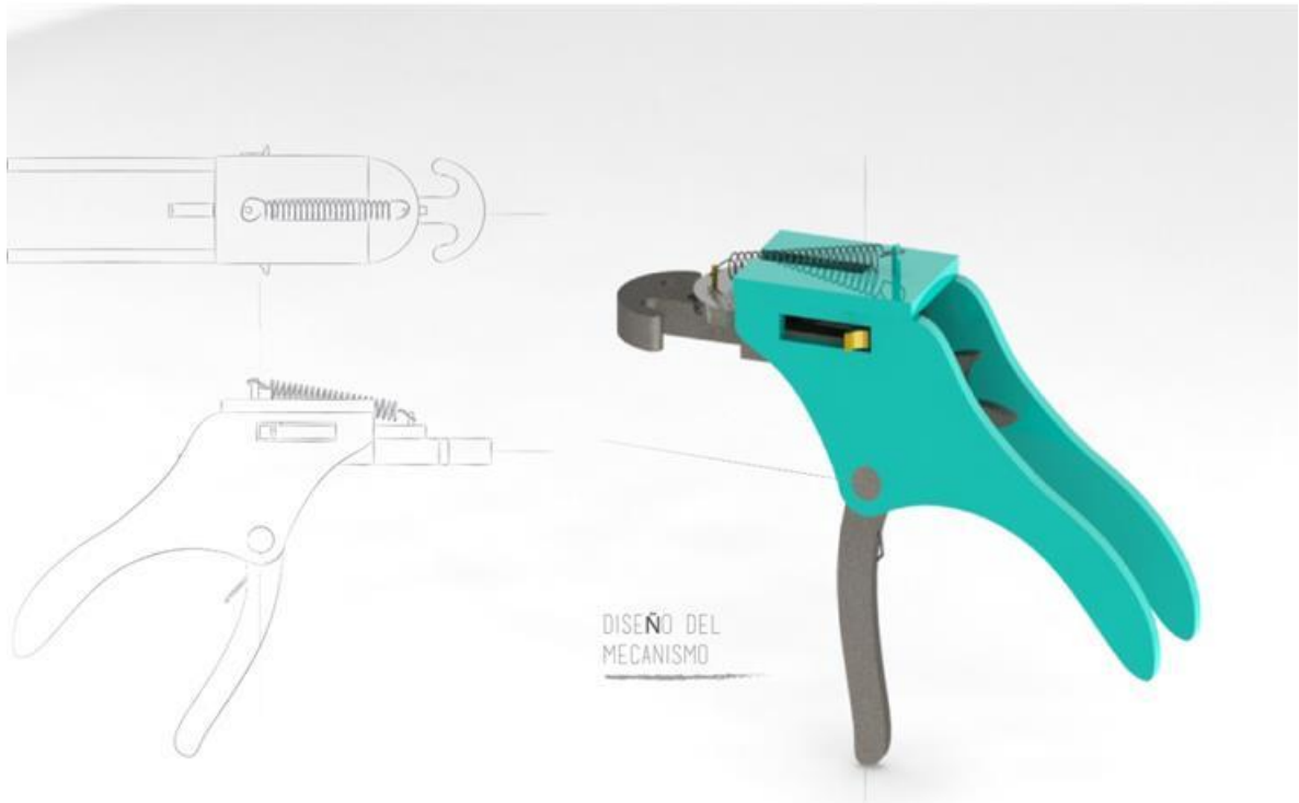
Figura 44. Rediseño del mecanismo seleccionado.
