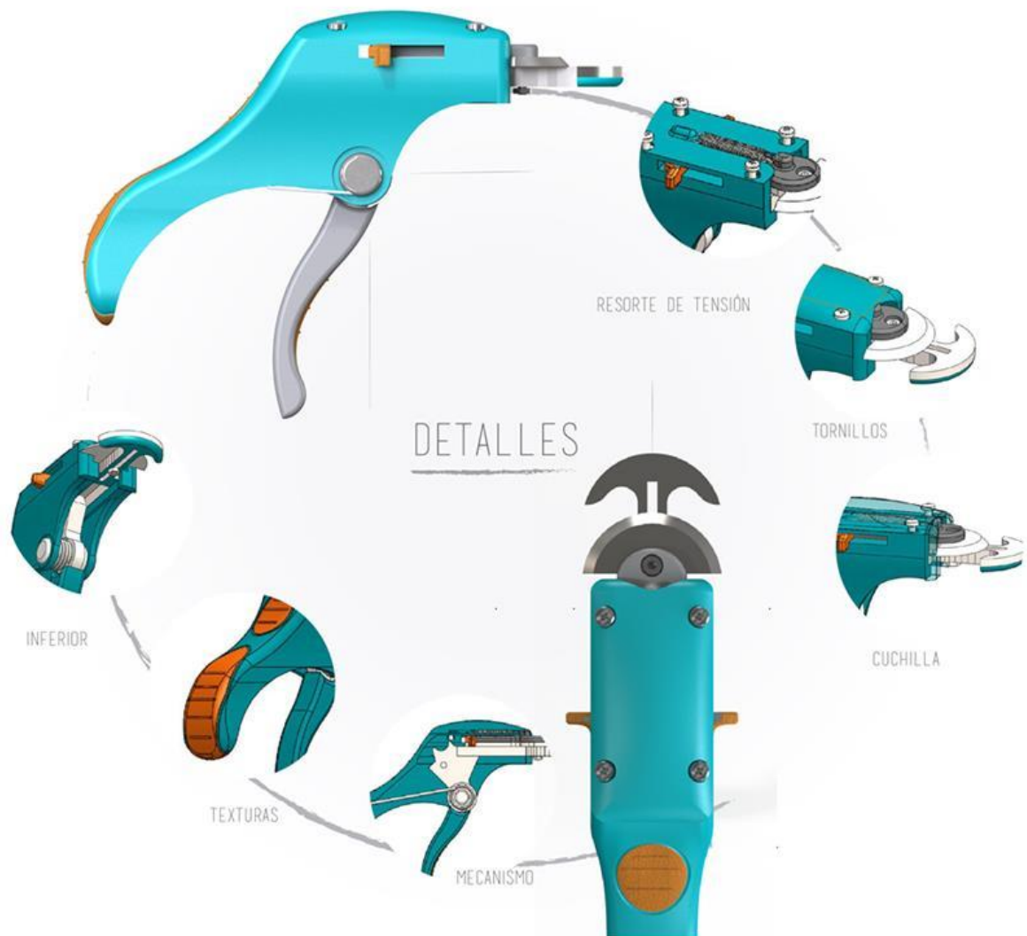
Figura 73. Vistas de detalle de la herramienta de corte.
