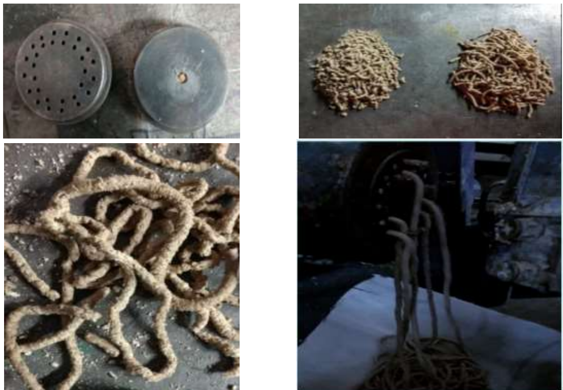
Figura 71. Variación del diámetro y longitud del pellet
