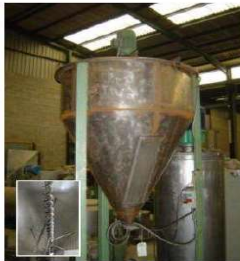
Figura 17. Mezcladora de tornillo sin fin vertical.
