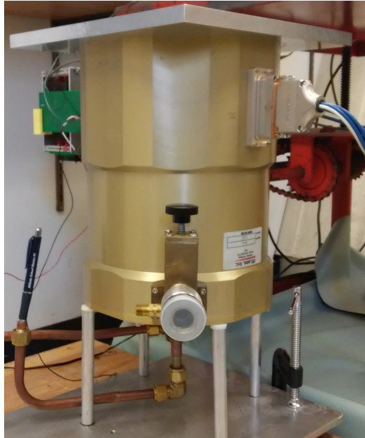
Figura 37. Dispositivo Dewar (o termo) empleado para medir la ganancia en los SiPM como función de la temperatura (desde -113^{\circ}\text{C} hasta 23^{\circ}\text{C} ).
