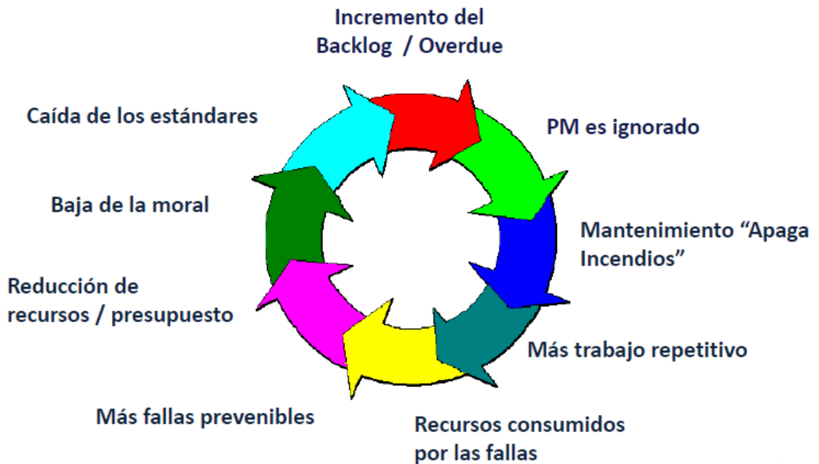
Ilustración 12: Ciclo reactivo del mantenimiento.
