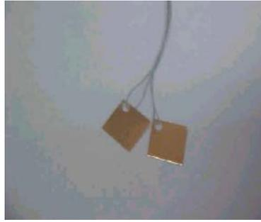
**Figura 7.** Probetas de oro para pulimento químico
