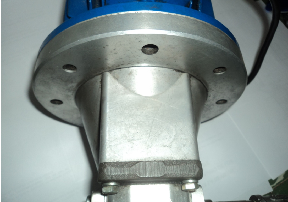
Figura 45. Sistema de acople del sistema motor-bomba
