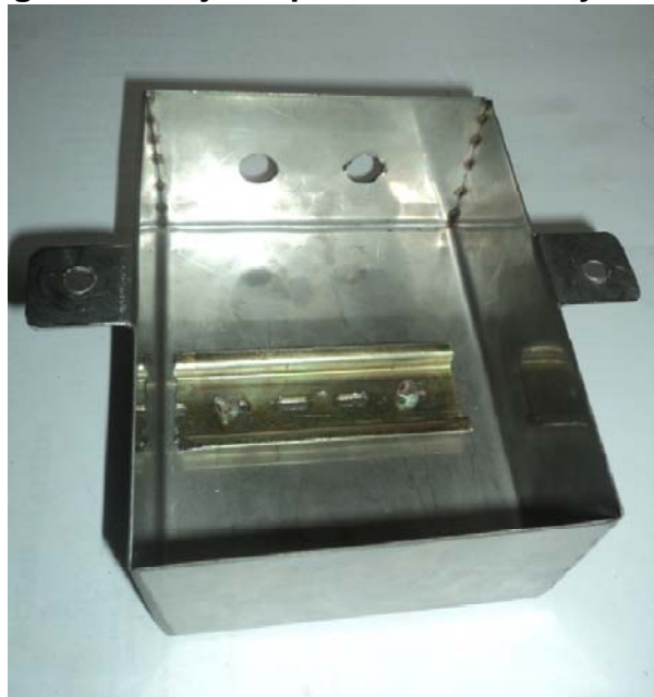
Figura 54. Caja de protección de disyuntor
