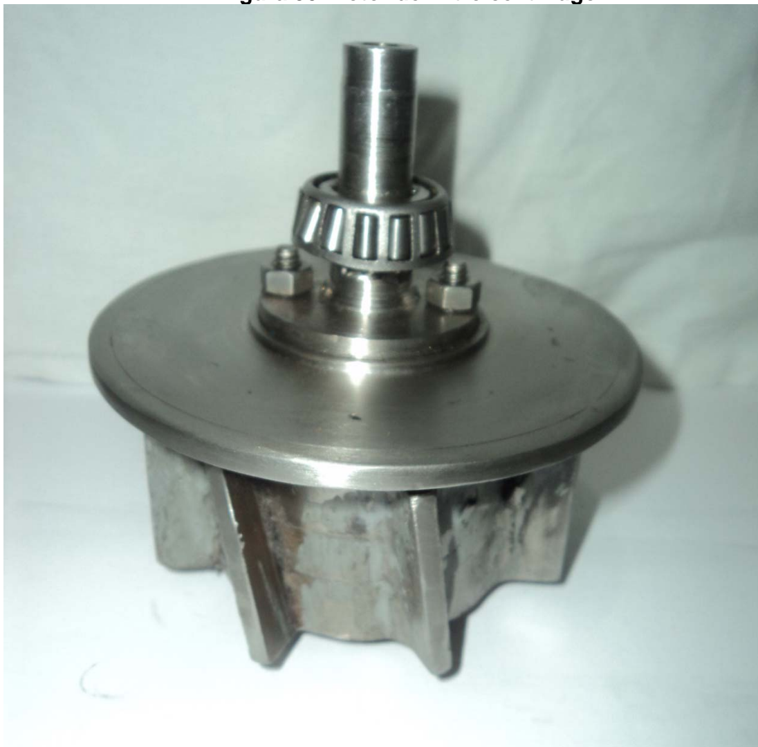
Figura 50. Rotor del filtro centrífugo
