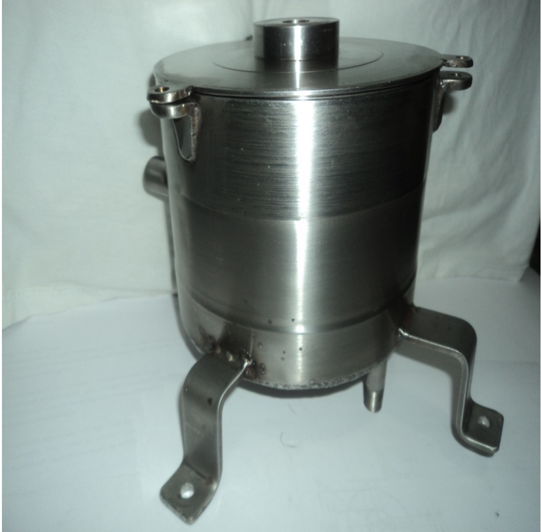
Figura 49. Carcasa del filtro centrífugo
