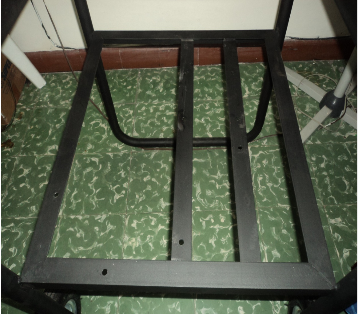
Figura 42. Orificios de acoplamiento a la estructura
