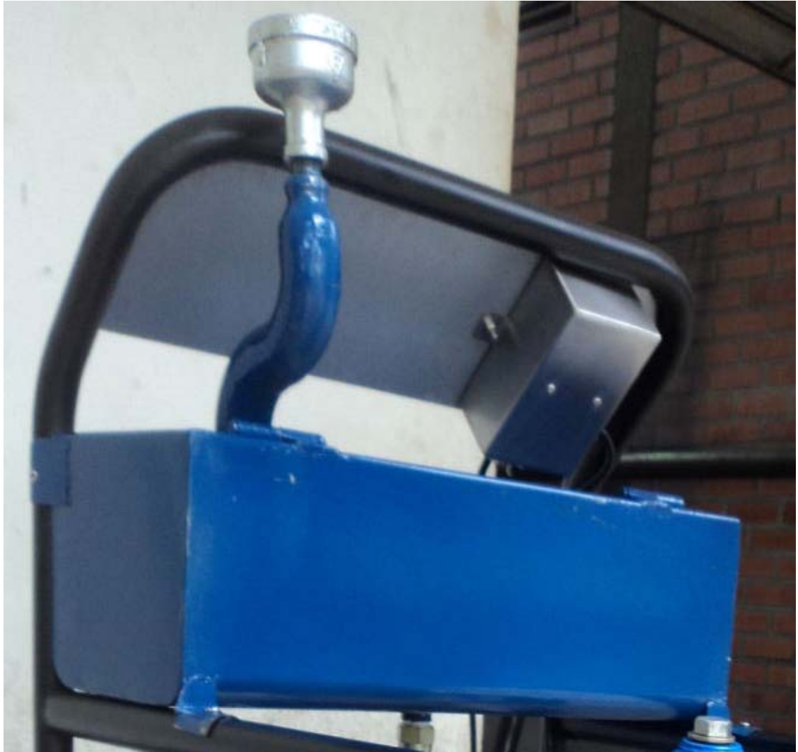
Figura 48. Tanque de almacenamiento
