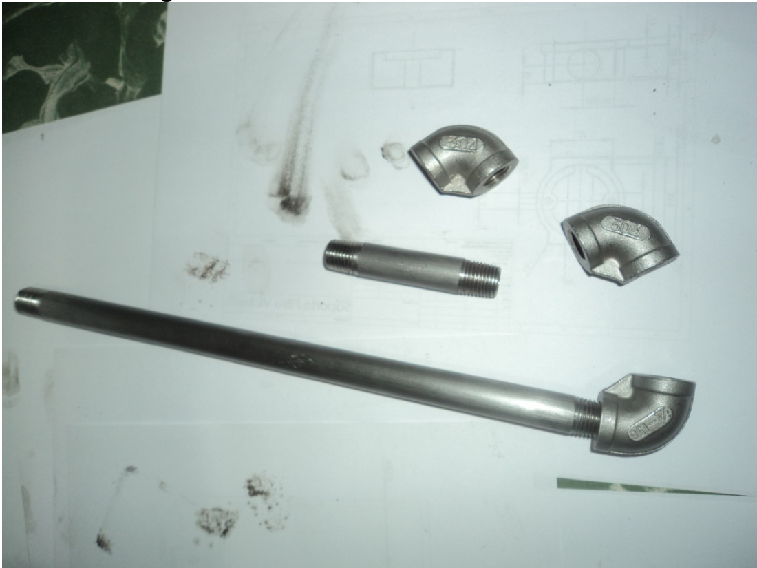
Figura 55. Tubería de acero inoxidable AISI 304 \frac{1}{4} "
