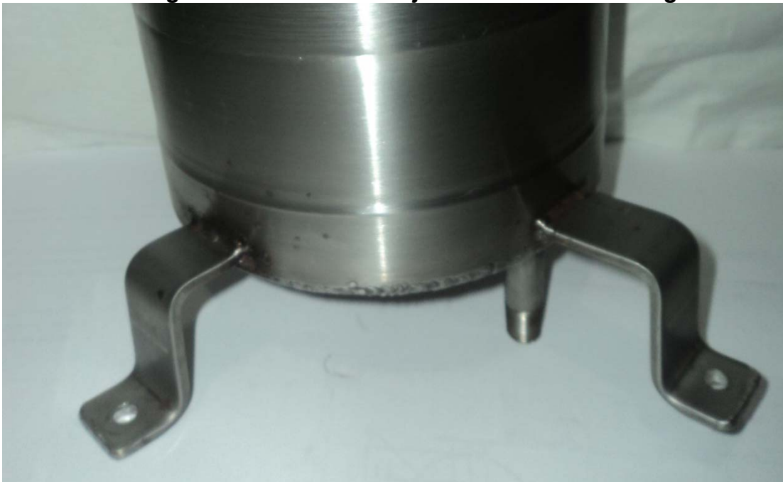
Figura 44. Platinas de sujeción del filtro centrífugo
