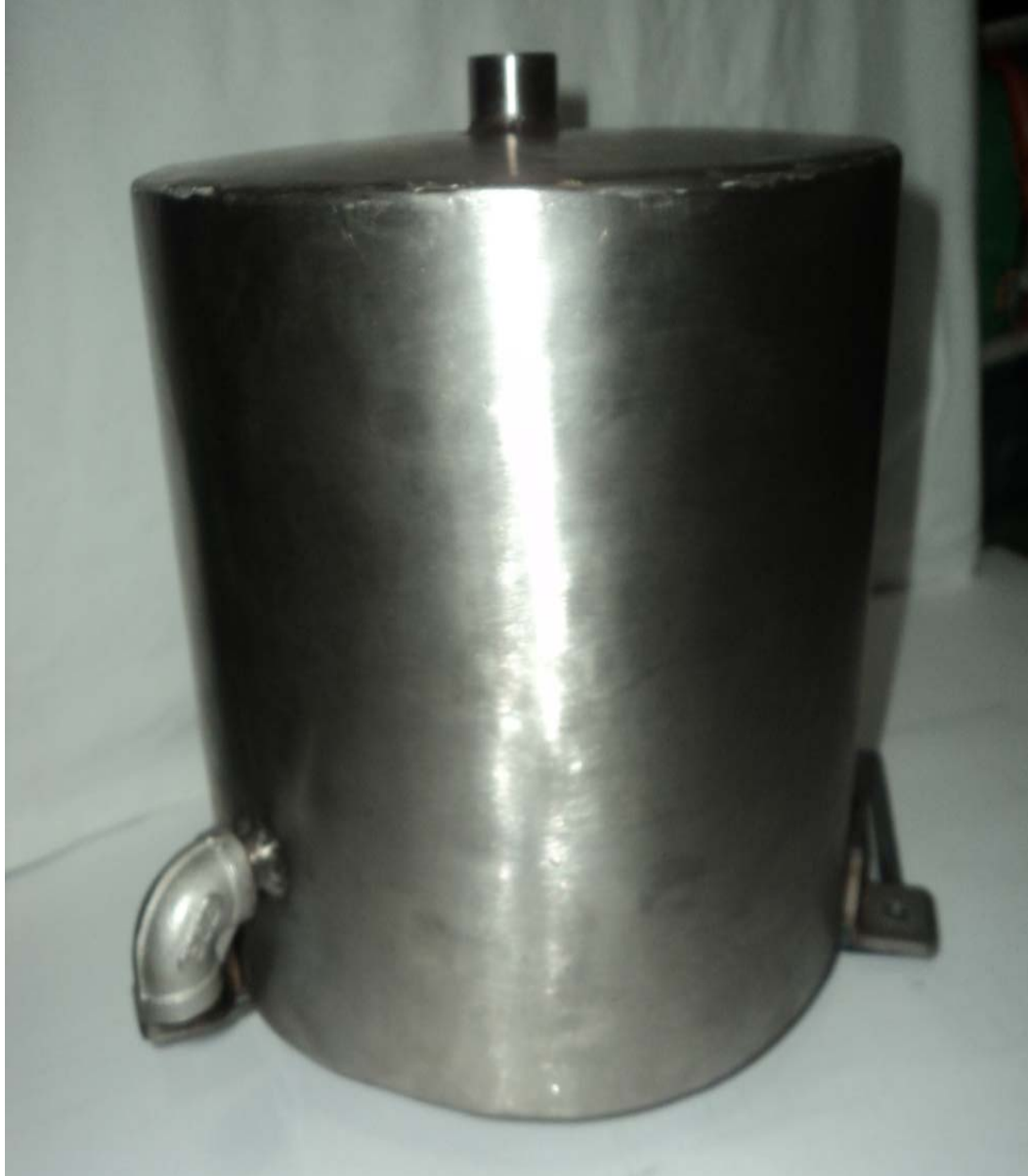
Figura 47. Tanque de almacenamiento
