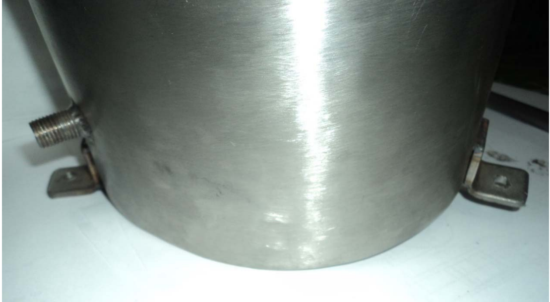
Figura 43. Platinas de sujeción del tanque
