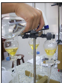
Figura 2.8 – Lavado del biodiesel
