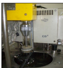
Figura 3.1 – Montaje preliminar. Catalizador 0,8%, T= 50°C yRMA 12:1
