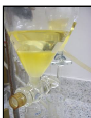
Figura 2.6 – Decantación T= 50°C
