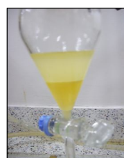
Figura 2.7 - Decantación T= 70°C
