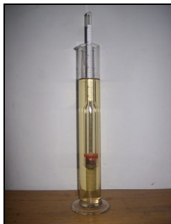
Figuro 2.10 - Determinación de la densidad por medio del densímetro
