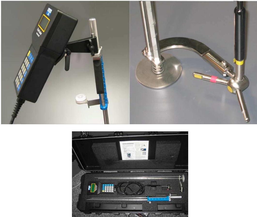
Figura 7.1. Montaje del control y la sonda en el soporte
