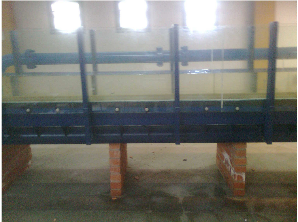
Figura 20 Canal de pendiente variable
