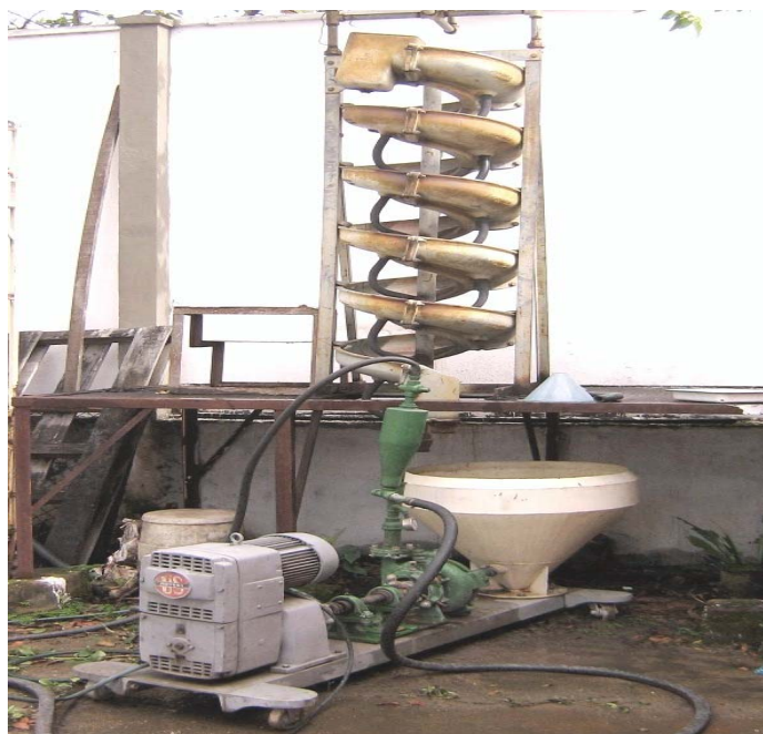
Figura 6. Vista del Espiral Humphreys utilizado en la concentración gravimétrica
