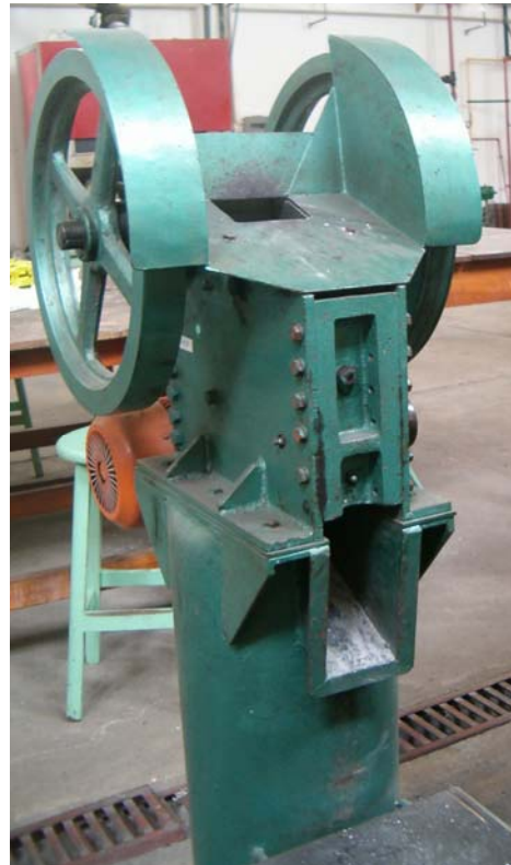
Figura C.7. Trituradora de mandíbula (Laboratorio de Ing. Química, UIS)
