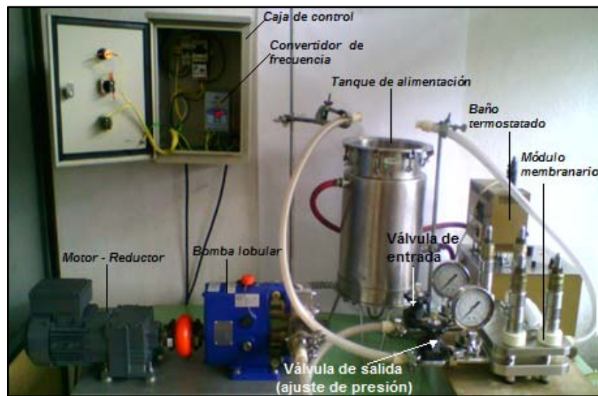
Figura 7. Montaje del sistema membranario.
