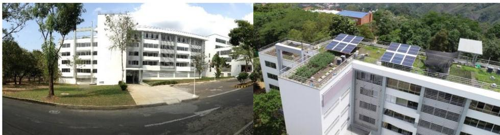
El edificio fue diseñado y construido teniendo en cuenta distintas estrategias de uso racional de la energía (URE), como iluminación y ventilación natural, cubierta verde ubicada en la terraza, sistema de automatización y sistema de generación FV, entre otros.
