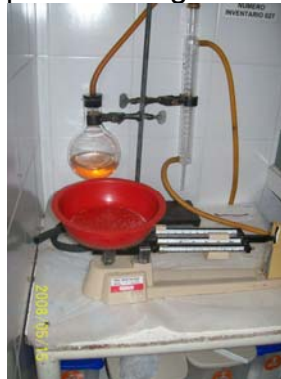
Figura 32. Inspección de grados alcoholímetros
