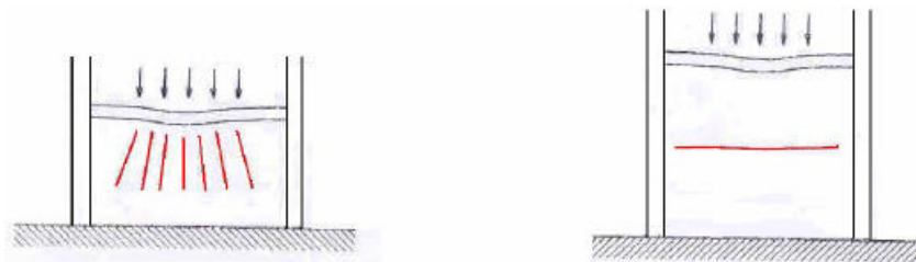
Figura 42. Fisuras en tabiques de planta baja (poca altura y esbelto).
