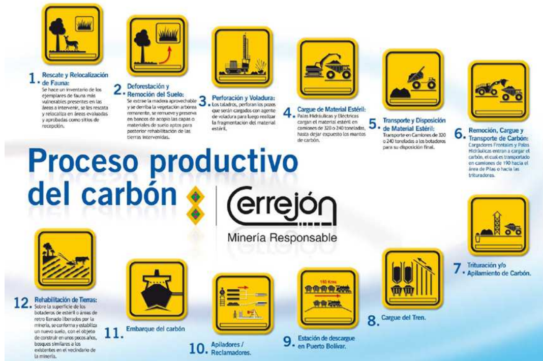
Figura 2. Proceso productivo del carbón
