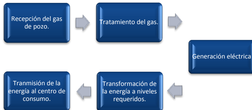
Figura 3 Diagrama de las etapas en un proceso de generación eléctrica a gas
