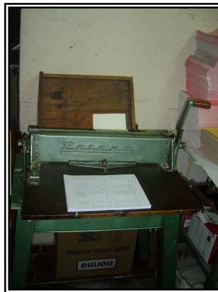
Figura 20. Centro de Trabajo de Perforado
