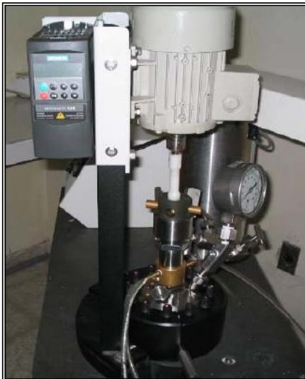
Foto 4. Cabezal rotatorio para las pruebas en el autoclave.
