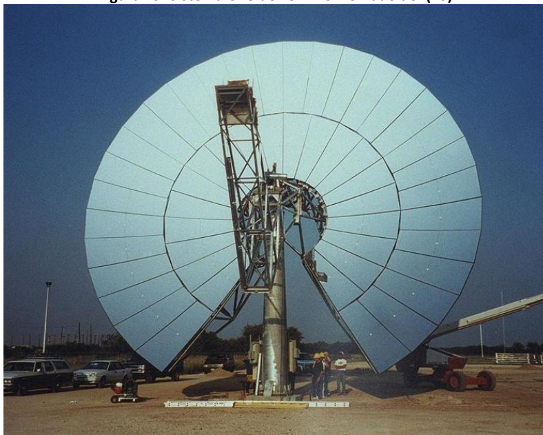
Figura 49. Sistema CPG de 25 kWe. Tomado de: (40)
