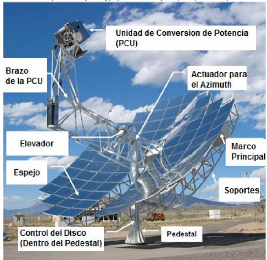
Figura 54. Unidad Disco-Stirling de Stirling Energy Systems (SES), y sus principales componentes. Tomado de: (48)
