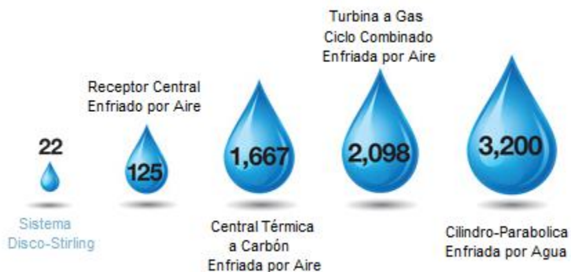
Figura 62. Cantidad de agua requerida en las tecnologías CSP. Adaptado de: (48)
