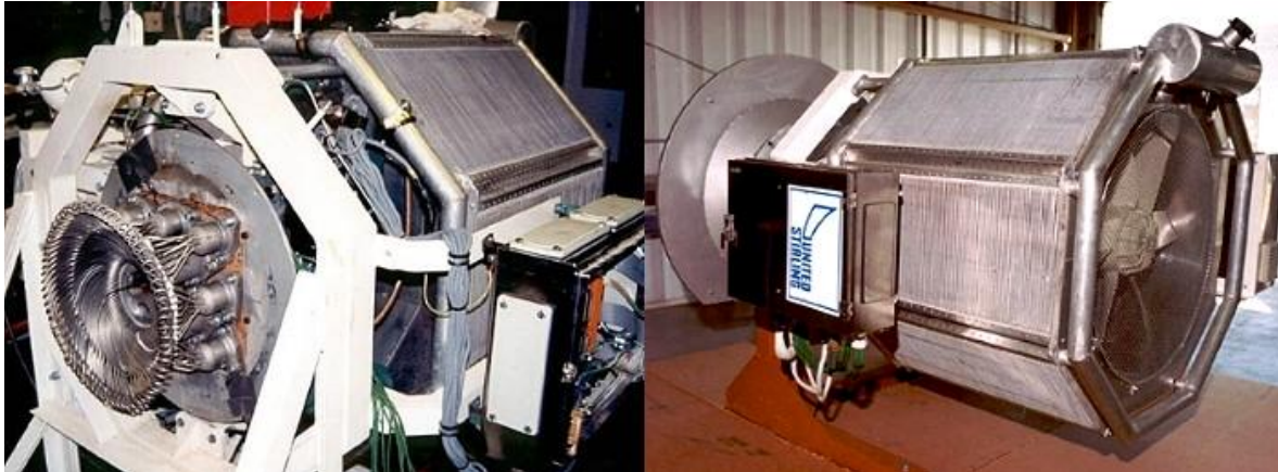
Figura 55. PCU usado en el SunCatcher con el Motor Stirling Kockums 4-95. Tomado de: (49)
