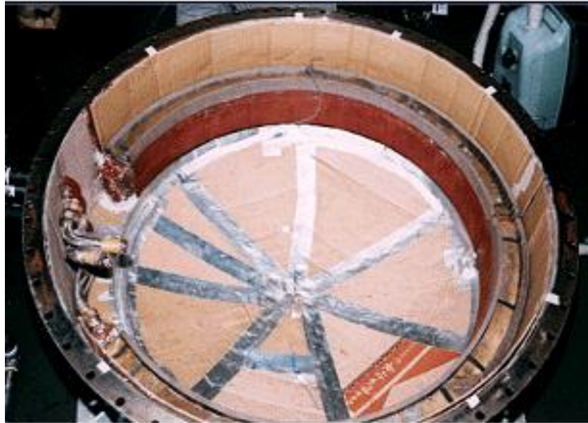
Figura 72. Fondo del motor Stirling de 300 W de la Universidad de Saitama y ubicación de los intercambiadores. Tomado de: (64)
