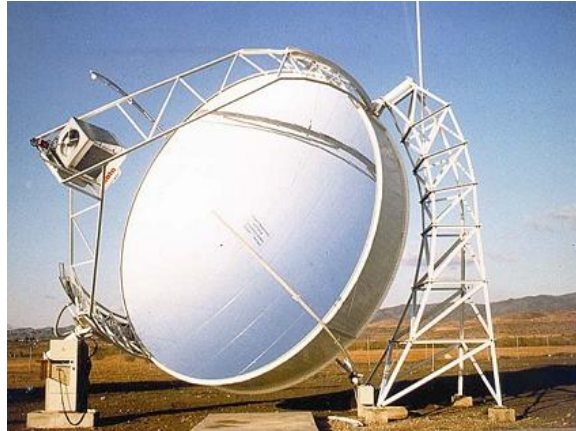
Figura 44. Un sistema DISTAL I en operación en la Plataforma Solar de Almería. Tomado de: (35)
