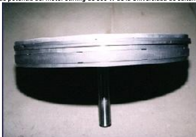
Figura 73. Pistón de potencia del motor Stirling de 300 W de la Universidad de Saitama. Tomado de: (64)
