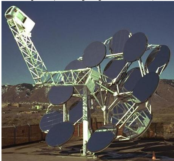
Figura 50. Sistema Disco- Stirling de SAIC/STM de segunda generación en Golden, Colorado. Tomado de: (40)
