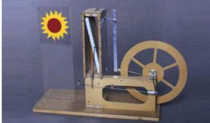
Figura 66. Motor Stirling de Bajo Diferencial de Temperatura "Flat Plate" de Ivo Kolin. Tomado de: (62)
