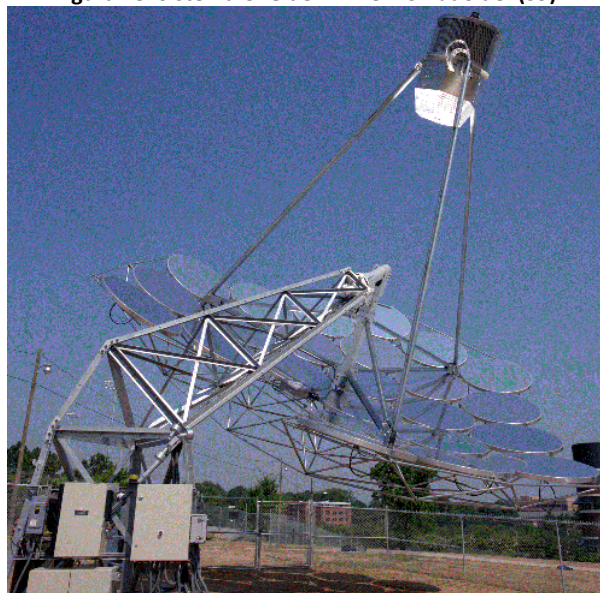
Figura 48. Sistema CPG de 7 kWe. Tomado de: (39)
