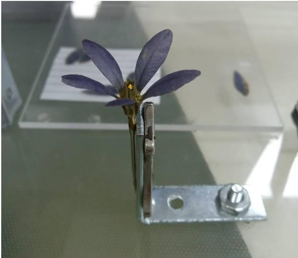
Figura 6. Forma de sujeción del pétalo al banco de pruebas.
