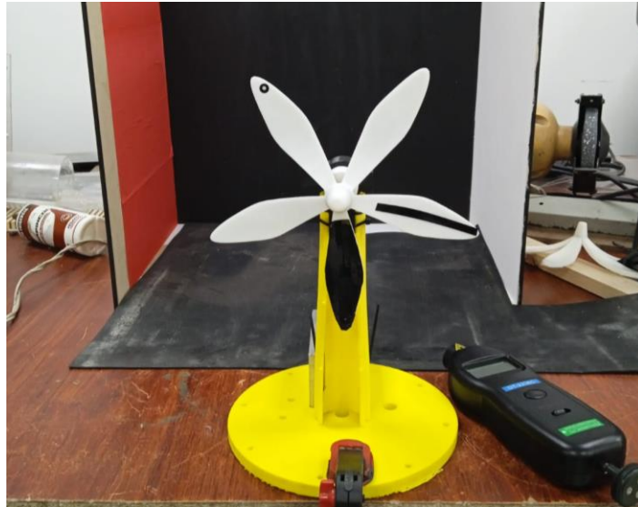
Figura 38. Medición RPM tacómetro.
