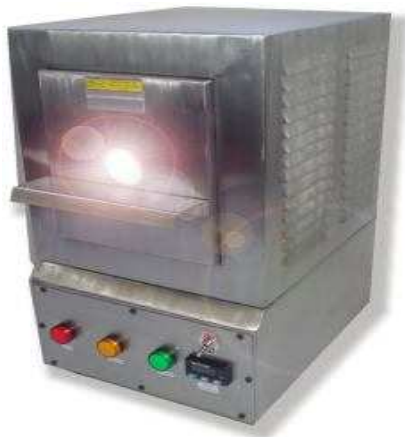
Figura 6. Horno eléctrico del laboratorio de transferencia de calor con el que se realizaron las pruebas de cálculo de humedad y Calor Específico.
