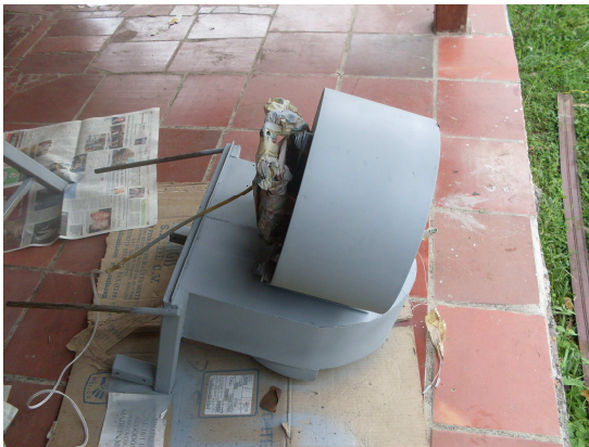
Figura 22. Fotos de la tolva de descarga.
