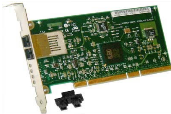
Figura 10. Tarjeta de Red Gigabit Ethernet de fibra óptica utilizada en la toma de datos.
