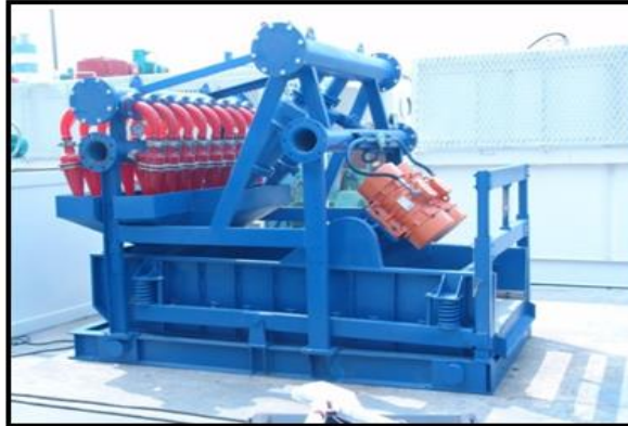
Figura 14. Limpiador de lodo.
