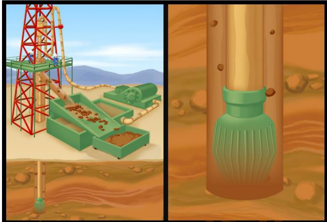
Figura 6. Circulación del lodo de perforación
