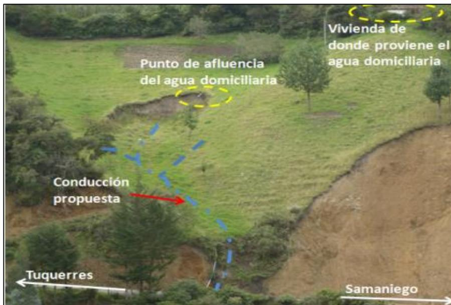
Figura 15. Escarpe producto de la descarga de aguas domiciliarias KM17+850
