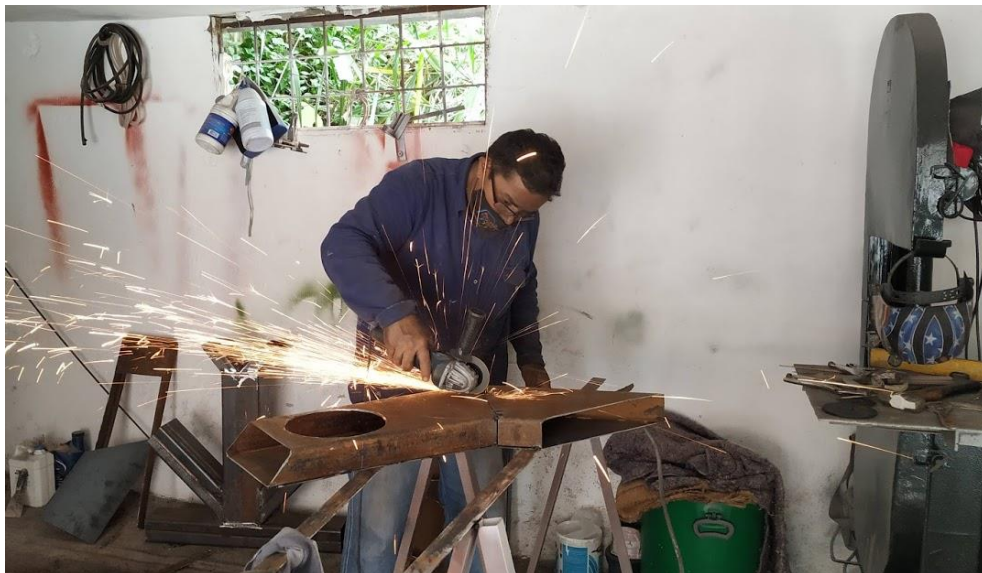
Figura 26. Corte de las hornillas en los ductos.
