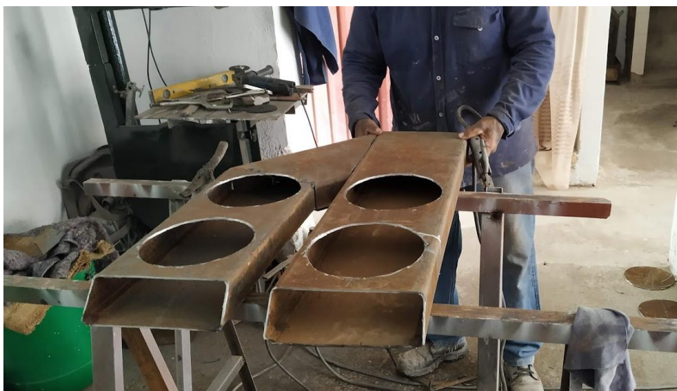
Figura 27. Alineación de los ductos de las hornillas para ser soldados.
