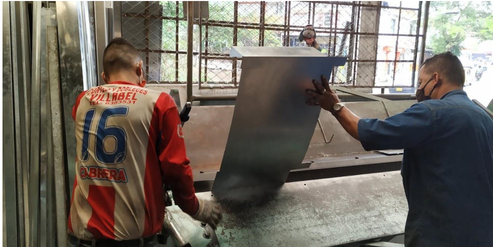
Figura 30. Obtención del protector del aislante en una maquina dobladora.
