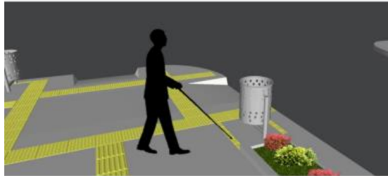
Figura 10. Esquema de Uso de Tabletas Podotáctiles en Obstáculos
