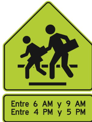
Figura 17. Señal de Cruce Escolar con Horario Institucional
