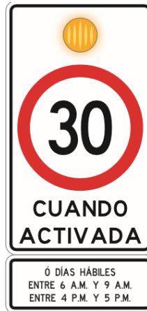
Figura 18. Señal de Velocidad Condicionada por Horario
