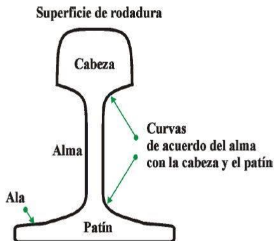
Figura 10. Sección transversal de un riel Vignole
