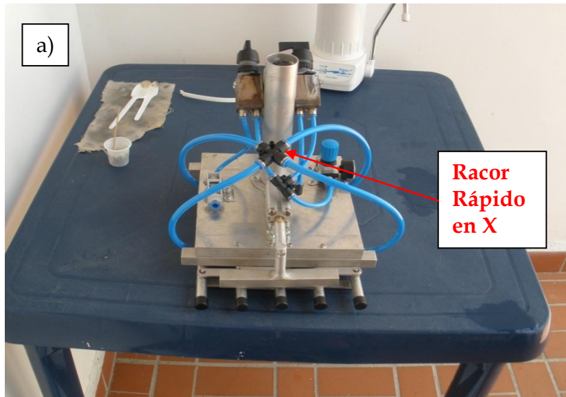
Figura 64. Cambio de conexión de Mangueras
