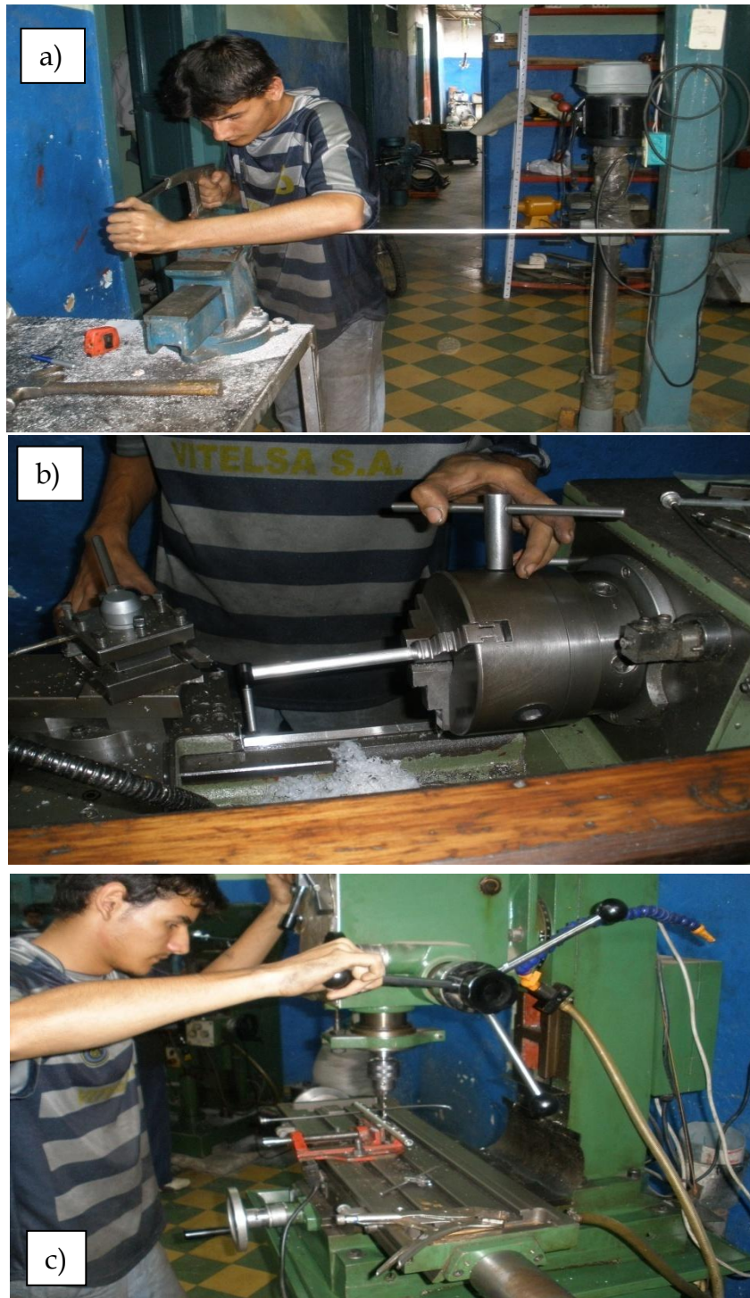
Figura 50. a) Corte tubo; b) Refrentado Partes; c) Perforación Tubos
