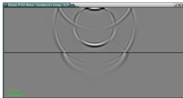
Figura 4.14: Componente v_z(x, t) , y t = 618 [ms] para un esquema de segundo orden de la ecuación elástica bidimensional en un medio semi-homogéneo
