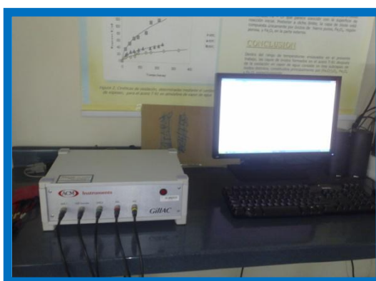
Fotografía 7. Fuente de corriente mas computador para medición de la impedancia electroquímica
