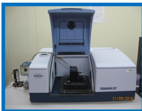
Fotografía 8. Equipo para la realización del ensayo infrarrojo por fotoacústica.
