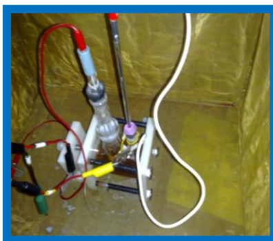
Fotografía 5. Montaje en la celda plana
