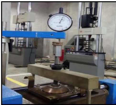
Figura 5 Muestra instalada e inundada en la maquina
