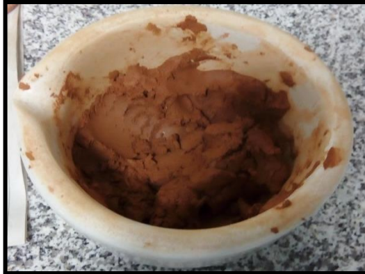
Figura 3 Muestra tamizada con humedad cercana al límite plástico
