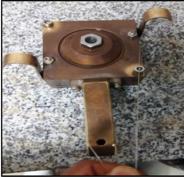
Figura 8 Muestra de suelo pre-cortada con tira de nylon
