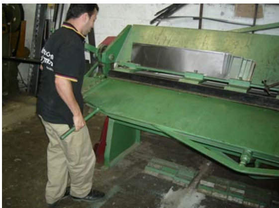
Figura 120. Proceso de doblado de lámina – Hablador
