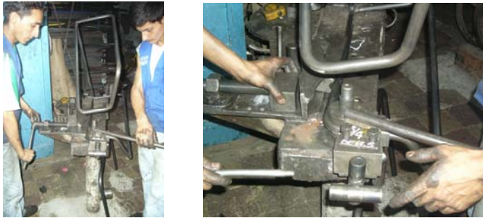
Figura 114. Proceso de doblado de tubo – Exhibidor
