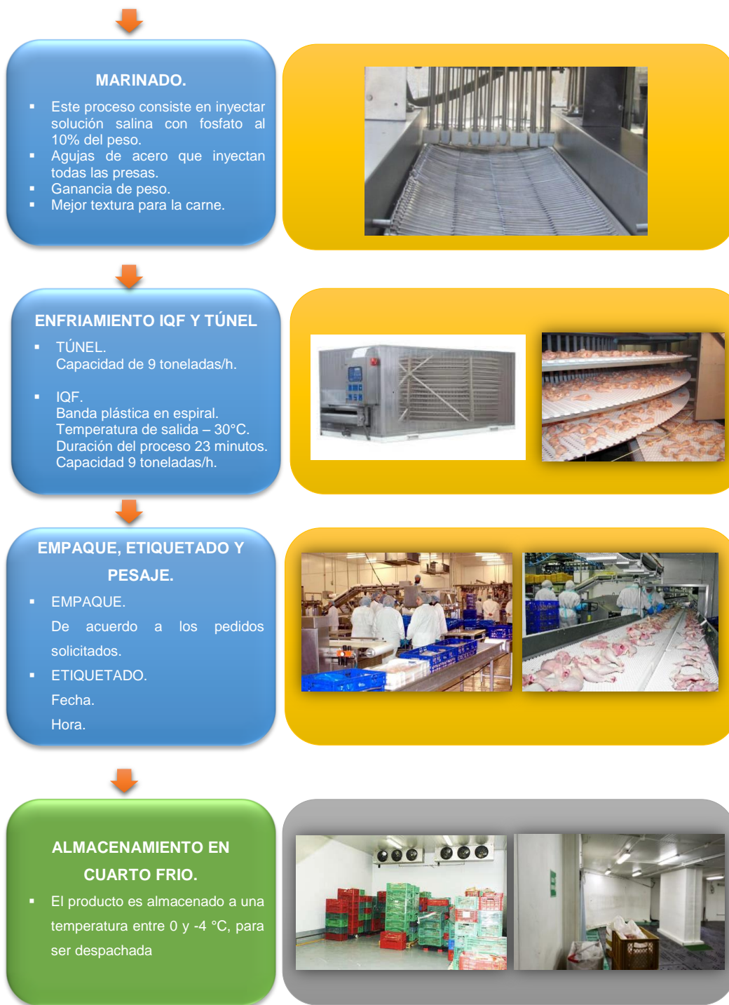
Figura 18. Esquema del proceso de beneficio avícola.
