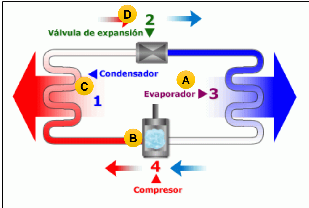
Figura 7. Ciclo básico de refrigeración.
