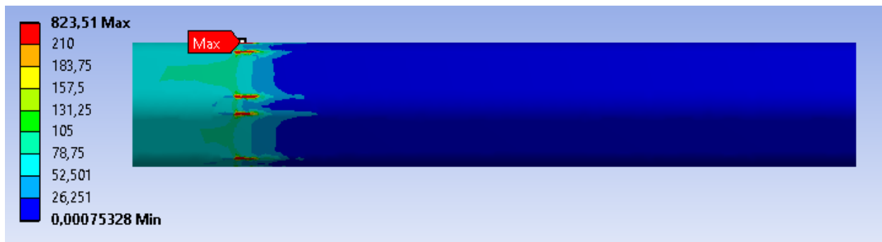
Figura 11: Esfuerzo Máximo en el Eje de 823.51 MPa
