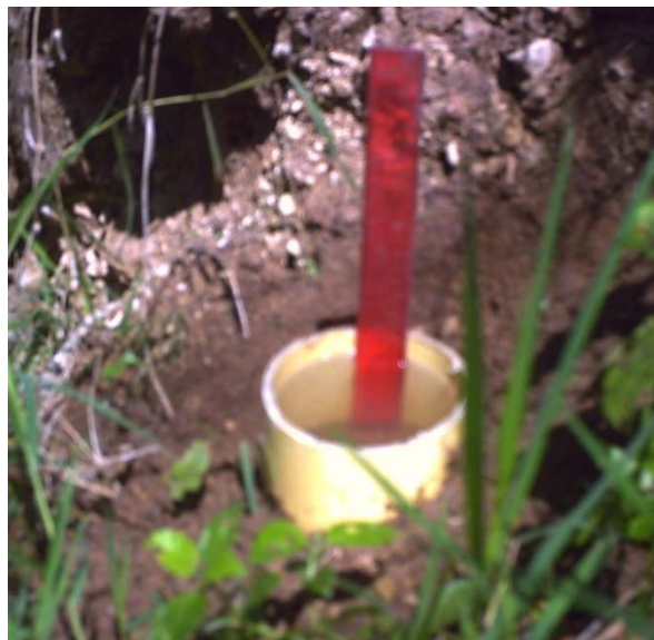
Foto 4. Ensayo de permeabilidad sobre la trinchera 5
