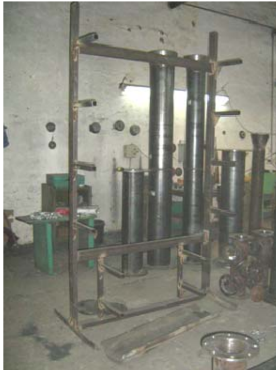
Figura 85. Estructura soporte de tubos de medición y medidores.
