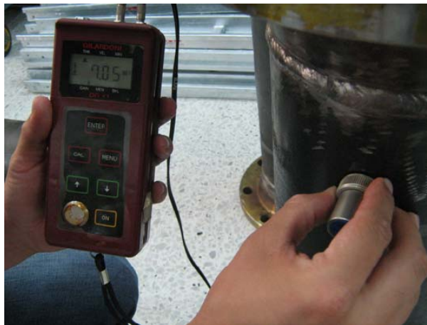
Figura 94. Medida de espesores de tubería.
