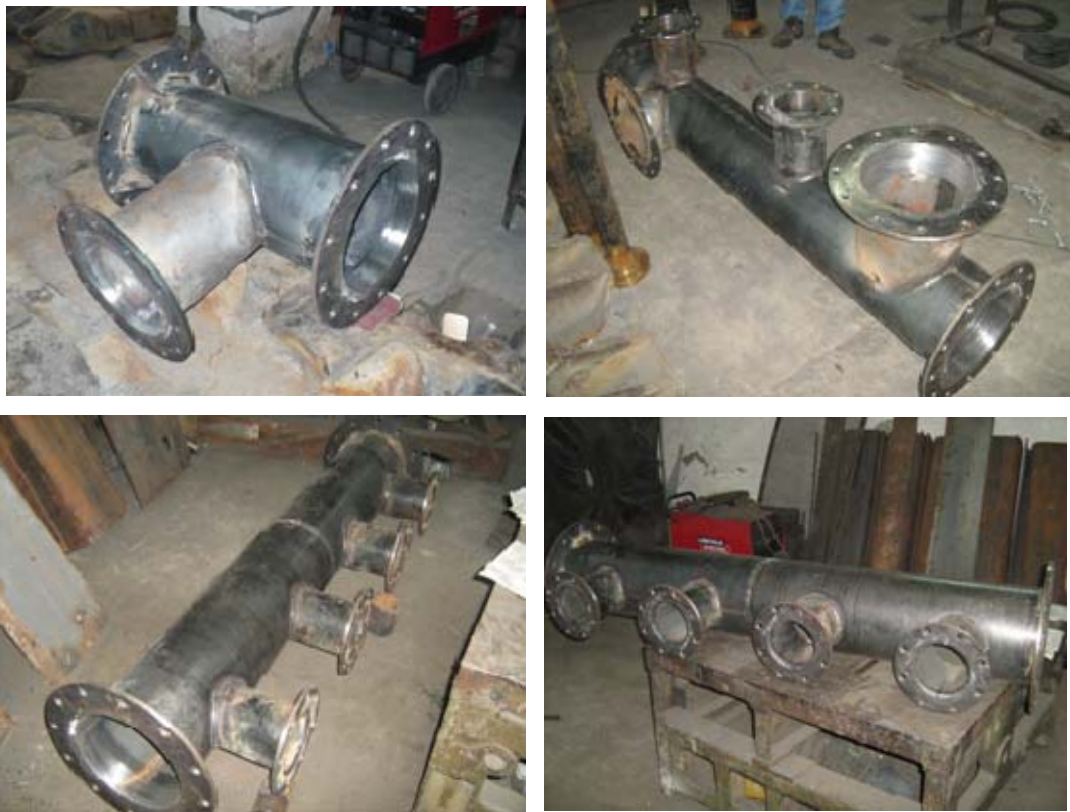
Figura 81. Construcción tubería en lamina de espesor 2.5 mm.
