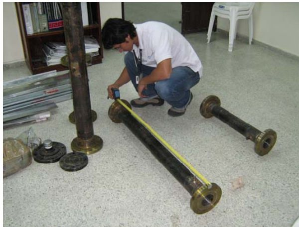
Figura 92. Medición longitudinal de tubos.
