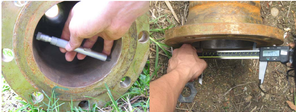
Figura 93. Medición diametral de tubería.
