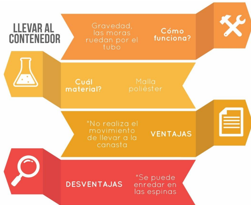
Figura 85 Llevar al contenedor mediante un tubo.
