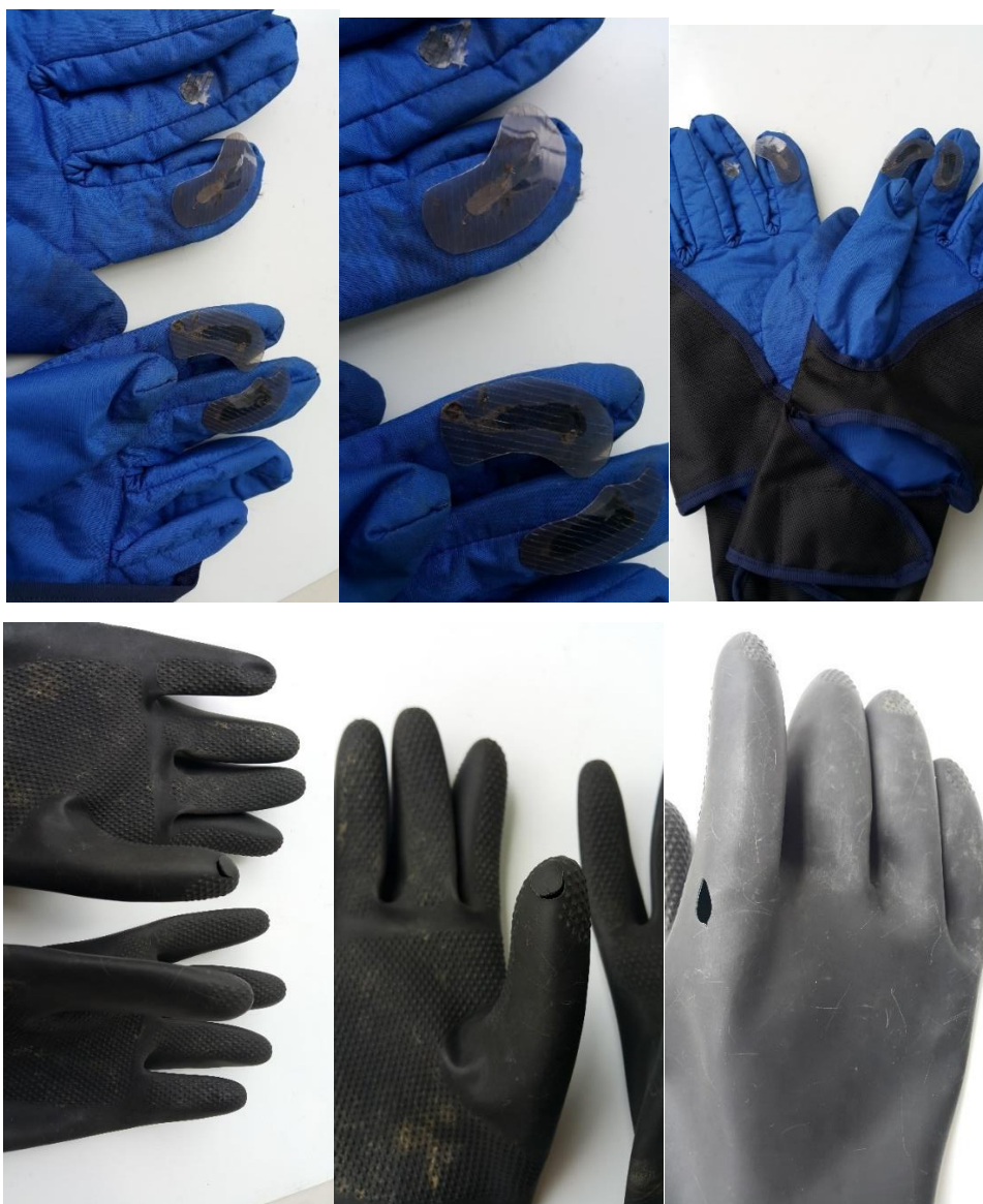
Figura 134 Desgaste presentado en la jornada de validación.
