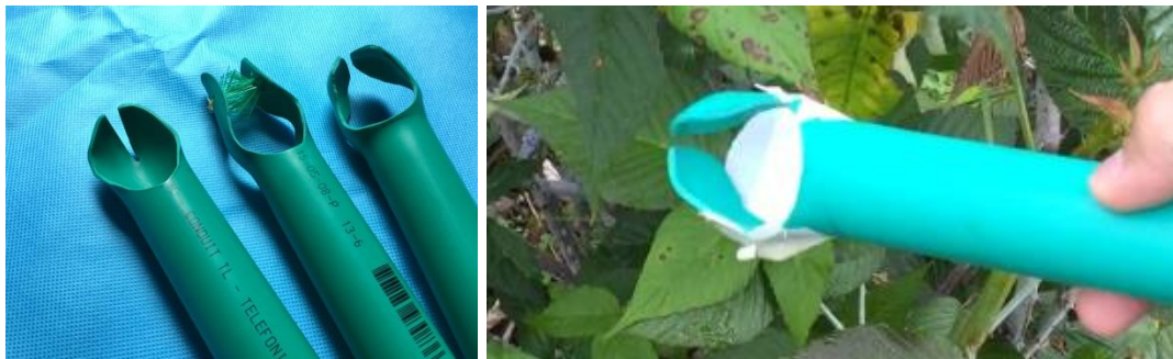
Figura 87 Propuesta de la cabeza de la herramienta en PVC.
