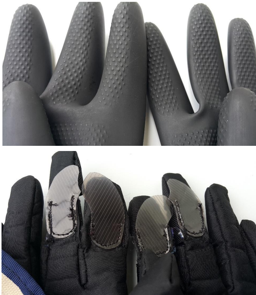
Figura 135 Desgaste del material para la segunda sección
