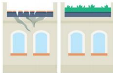
Figura 42. Impermeabilización en cubierta verde.
