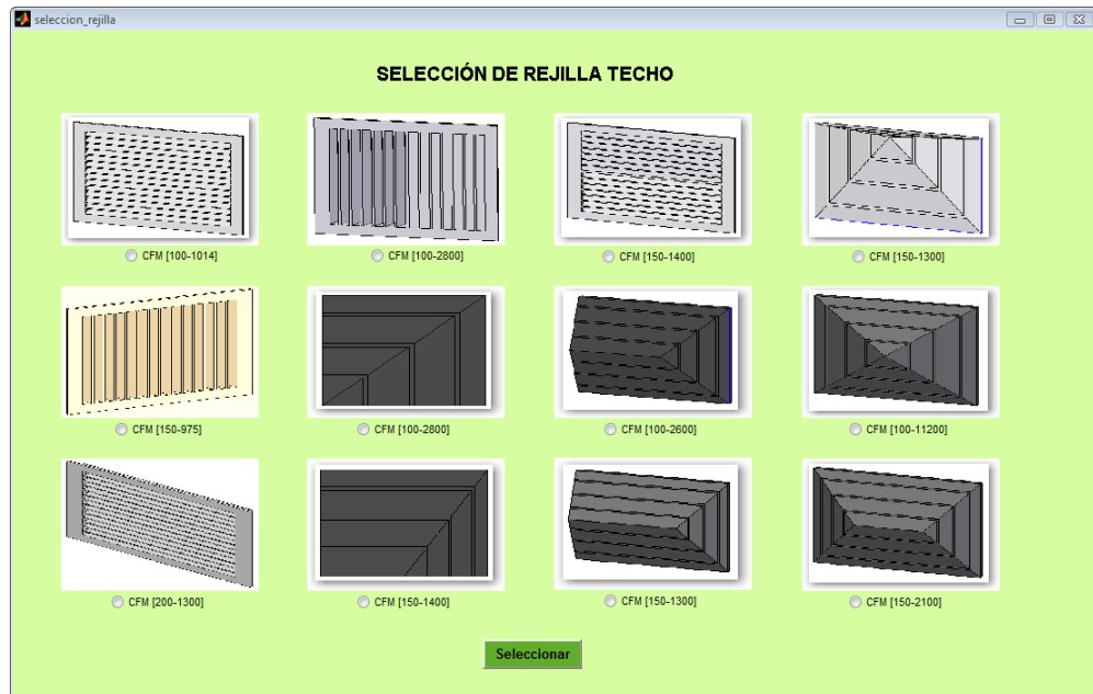
Figura 111. Rejillas de techo
