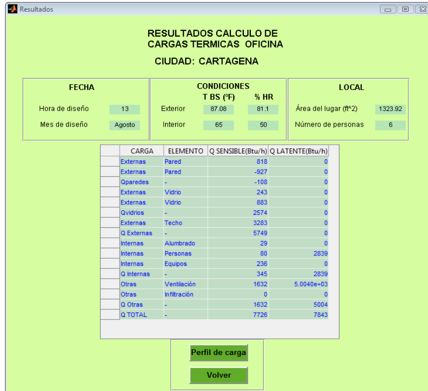
Figura 84. Resultado del cálculo de las cargas térmicas del recinto
